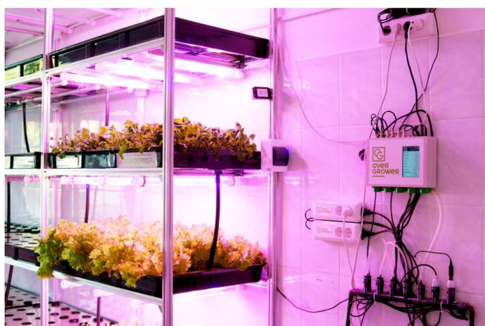
Использование измерительных возможностей прибора OverGrower™ даёт уникальную возможность для создания новых подходов в моделировании и прогнозировании биологических систем, в таких как гидропонные фермы. Для индивидуального использования при домашнем выращивании, прибор позволяет заменить агронома и избавить сити-фермера от рутинных задач, связанных с добавлением удобрений и отслеживания параметров раствора, что фактически
